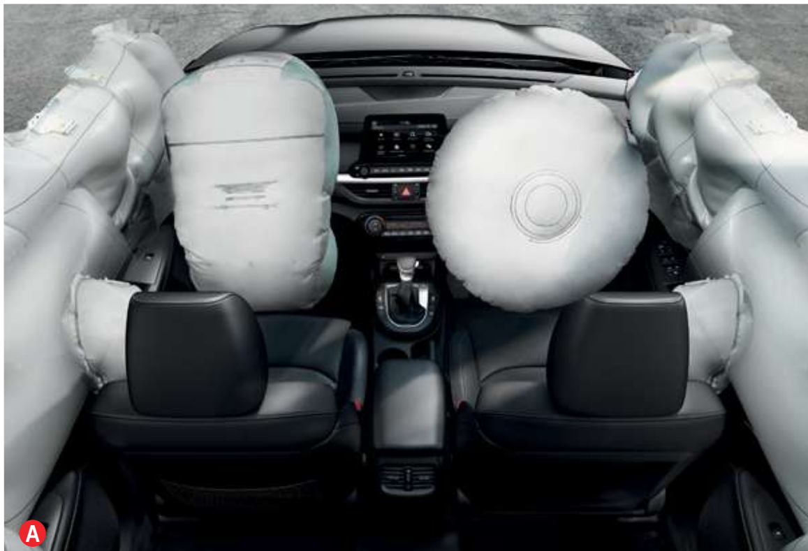
A SISTEMA DE 6 BOLSAS DE AIRE Cuenta con bolsas frontales y laterales para conductor y copiloto. Además cuenta con bolsas tipo cortina en cada lado.
